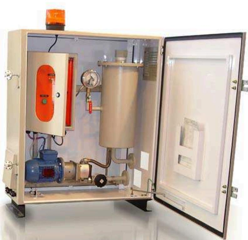
El sistema de deshidratación y filtrado **PROTECTOR CBC®**, acondiciona el aceite sin interrupciones del servicio, tratándolo durante intervalos de tiempo predeterminados en frecuencia y duración, o con cada conmutación.
